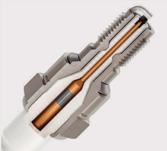
O eletrodo central possui núcleo central de cobre profundamente inserido dentro da ponta de liga de níquel, melhorando muito a dissipação de calor e prevenindo o superaquecimento do motor.
