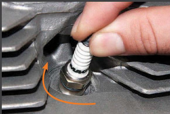
A vela deve ser colocada e girada com a mão até o assento do castelo encostar no motor. Depois use a chave de vela e siga as instruções conforme a tabela da página 278. Cuidado: o aperto excessivo pode quebrar a cerâmica. No entanto a falta de aperto também pode causar o superaquecimento ou pré-ignição.
