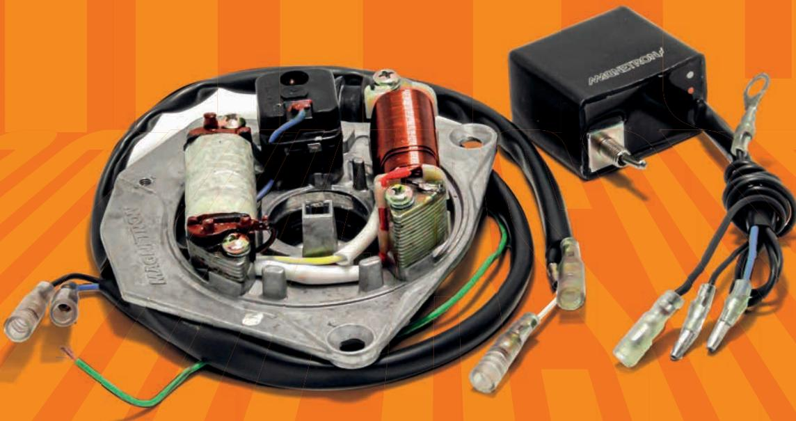
➤ O kit conversor tem a função de substituir o sistema à platinado por um sistema eletrônico, utilizando CDI.
